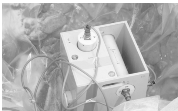
Рис. 4. Индукционный магнитометр для измерений вариаций и микропульсаций геомагнитного и геоэлектрического полей
