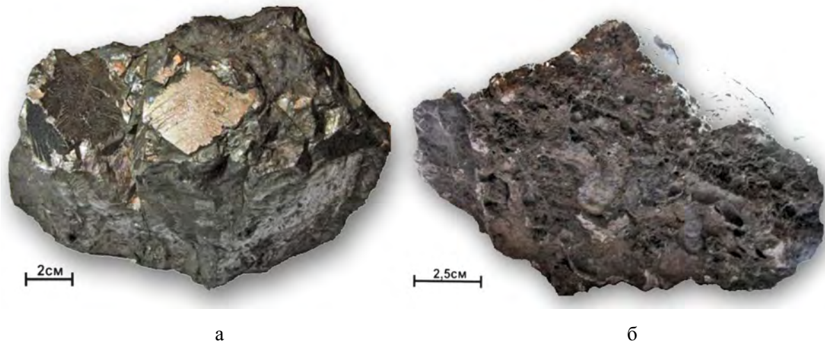
Рис. 2. Зовнішній вигляд зразка: а – сторона зразка з елементами кристалічної огранки та штриховки; б – оплавлена частина зразка (зворотний бік)
