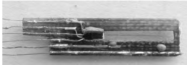
Рис. 7.19. Загальний вигляд чутливого елемента сенсора температури з терморезистивним принципом дії.
