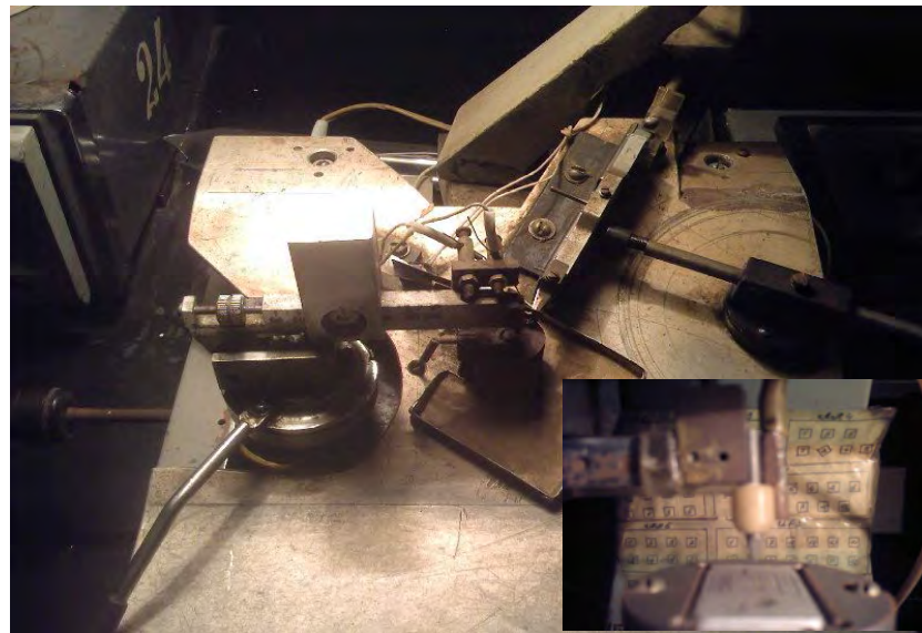
Рис. 2.14. Загальний вигляд установки для створення електричних контактів до вирощених НК Si.
