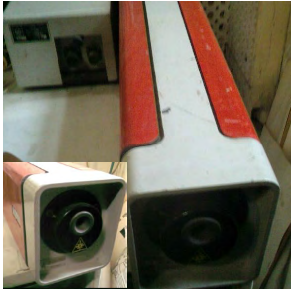
Рис. 2.13. Устава лазерної обробки полікремнієвого шару на базі твердотільного лазера ЛТН103.
