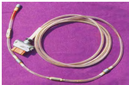
Рис.1.24. Мініатюрний сенсор для гастроентерологічних досліджень.
