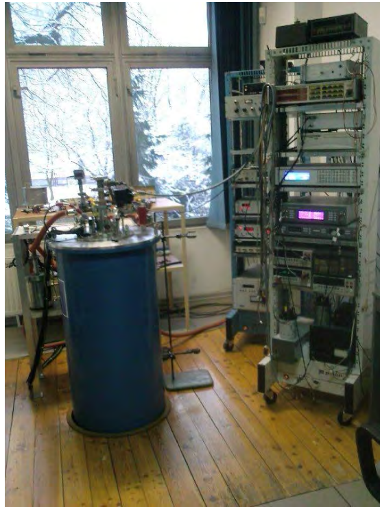
Рис.2.20. Фотографія вимірювальної установки на базі Lock In Amplifier 7265 DSP фірми Amitek.
