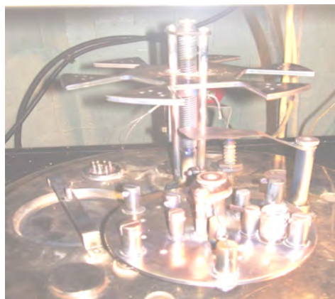
Рис. 2.1. Модернізована установка для вакуумного напилення плівок металу.
