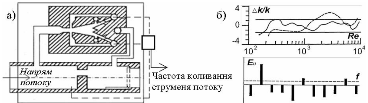
Рис. 1.8. Схема перетворювача коливань струминний автогенератора а) у частотний сигнал б) для перетворювача СГ-1
