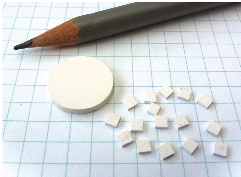
Рис. 2.2. Зовнішній вигляд досліджуваних зразків кераміки YAP:Mn,Hf , отриманої методом твердофазного синтезу.
