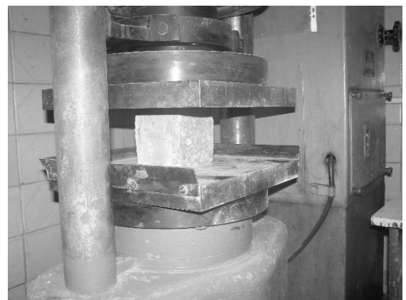
Рис.3.7. Дослідні бетонні зразки-куби та їх випробування
