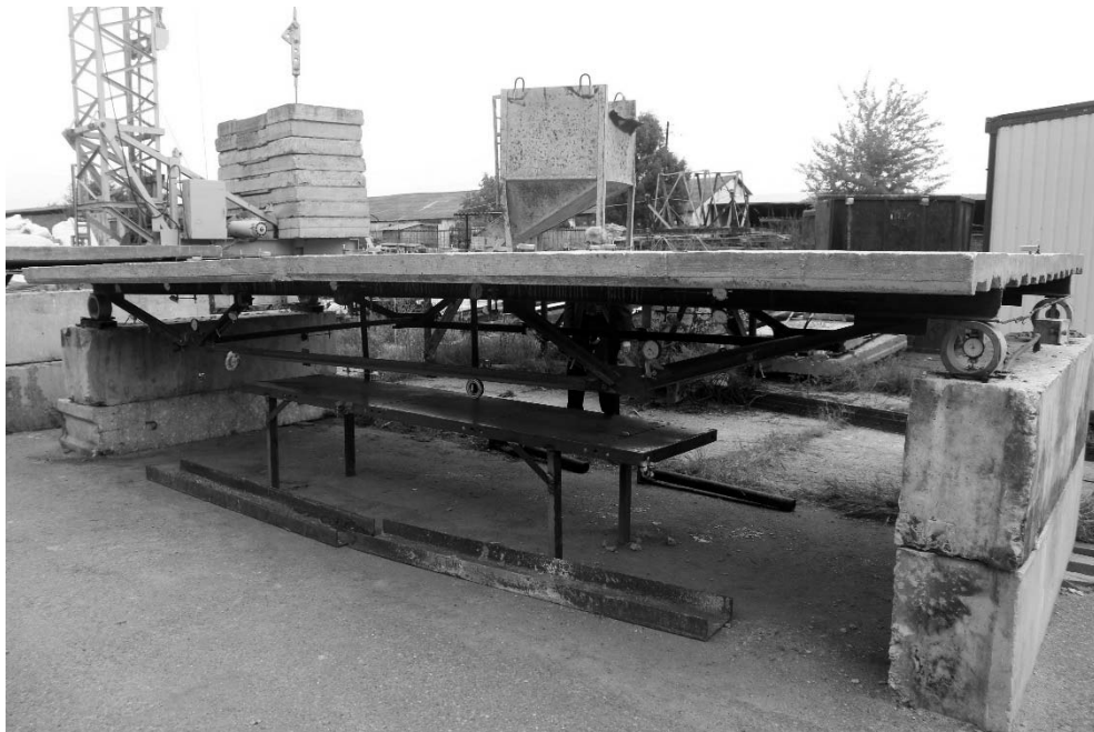
Рис.3.9. Загальний вигляд експериментальної конструкції після бетонування.
