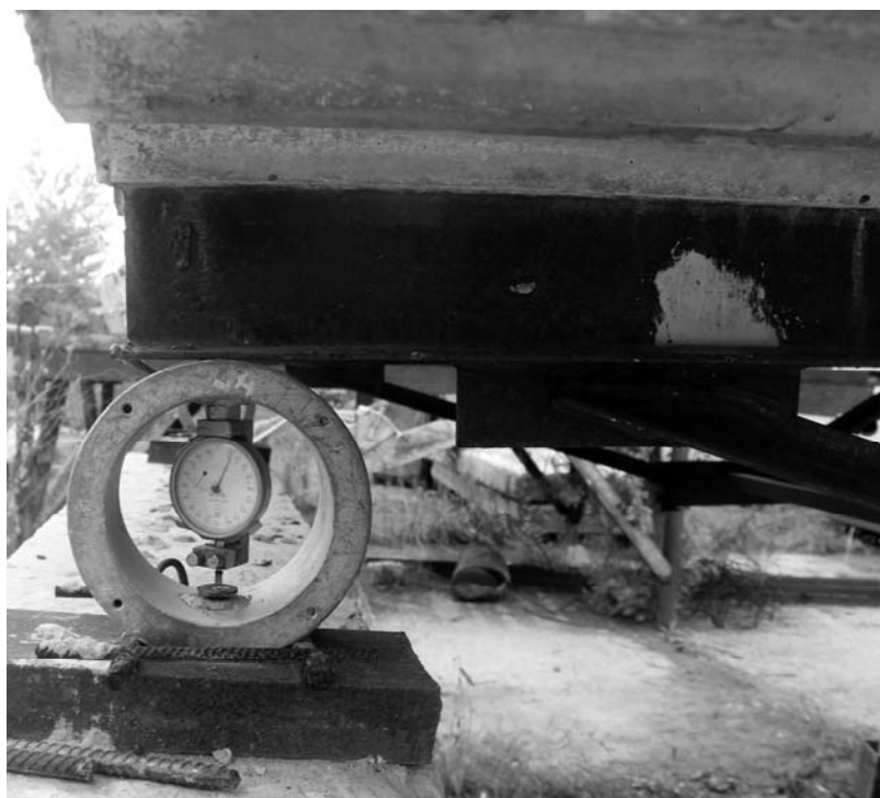
Рис.3.2. Опори дослідної конструкції
