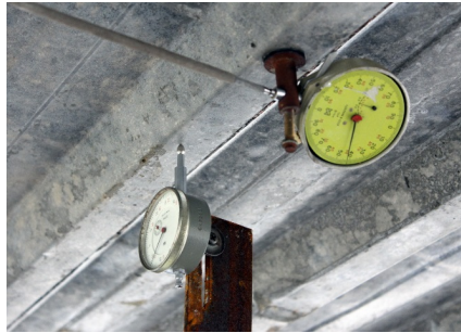
Рис. 8. Схема розташування приладів на залізобетонній плиті та металевих зв'язках: М – мікроіндикатори, П – прогиноміри, ТД – тензорезистори.
