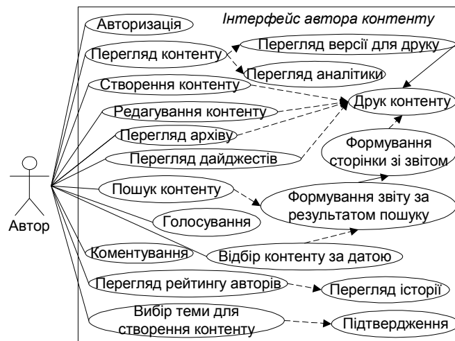
Рис. 7. Діаграма варіантів використання для інтерфейсу авторів контенту щодо інформаційного ресурсу в системах електронної контент-комерції
