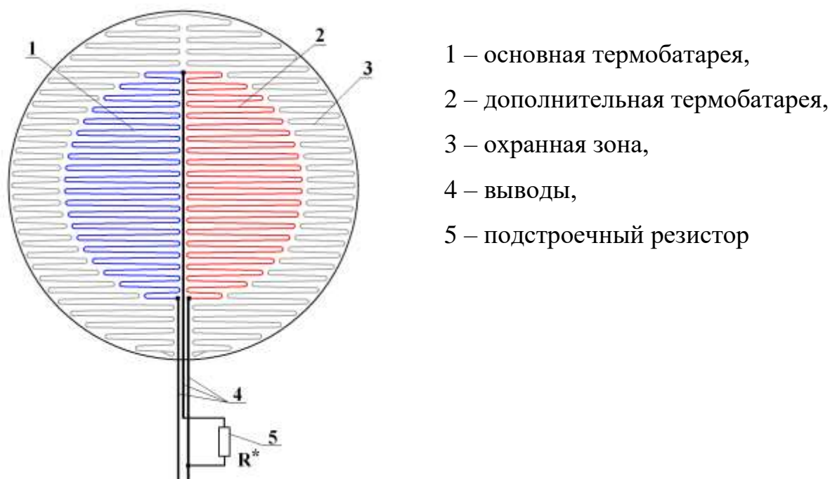
Рисунок 5.45 – Схема укладки термобатарей и подключения подбираемого шунтирующего резистора.
