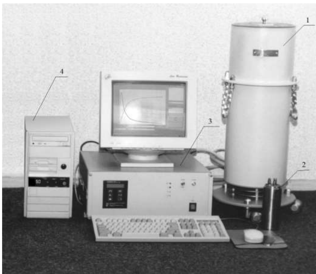
1 – тепловой блок (ТБ); 2 –бомба БКУ-2; 3 – электронный блок (ЭБ); 4 – персональный компьютер (ПК) с соответствующим ПО.
