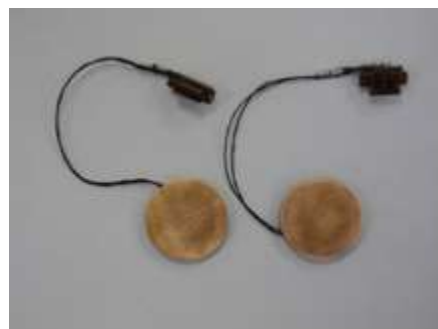
Терморезисторные преобразователи ДТП – М1, ДТП – М2
