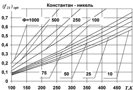
Рисунок 3.11 – Температурные зависимости оптимального отношения (f_{21})_{opt} = f(T) для константан-медного, константан-серебряного, константан-железного и константан-никелевого ПТП с наполнителем заливочного компаунда из плавленого кварца ( a ) и корунда ( б ) при вариации формпараметра \Phi
