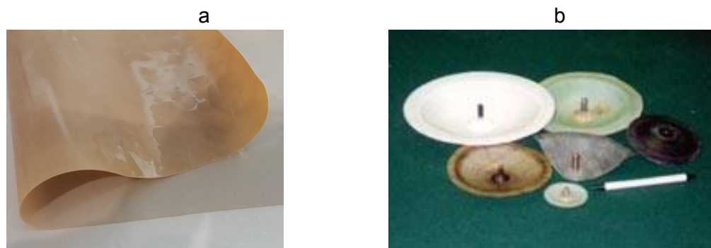
Рис. 1.3. Іонообмінні (а) [212] та композитні (б) [217] мембрани
