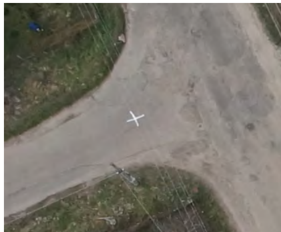
Рис. 2. Видяд розпізнавальних знаків намальованих на поверхні (аерознімання з БПЛА UX5, H = 150 м): а – кутподібний, б – хрестоподібний
