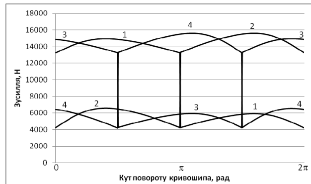
Рис. 7. Графіки зміни зусиль N_{11} - 1 , N_{12} - 2 , N_{21} - 3 та N_{22} - 4 залежно від кута повороту кривошипа
