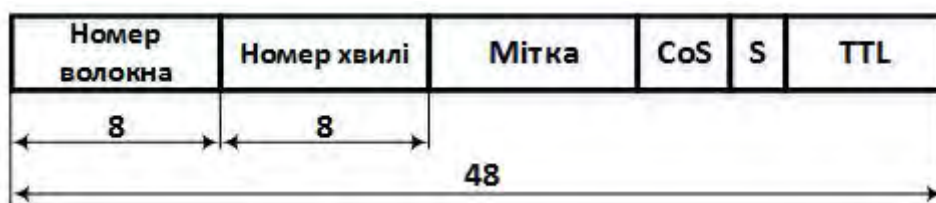
Рис. 1. Структура модифікованої мітки (довжини полів вказано в бітах)
