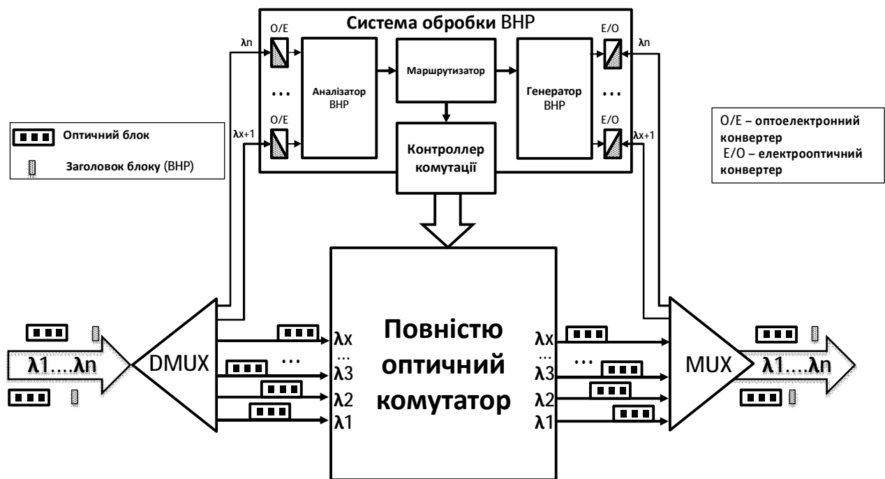
Рис. 3. Процес оптичної комутації блоків у центральному вузлі мережі з оптичною комутацією блоків
