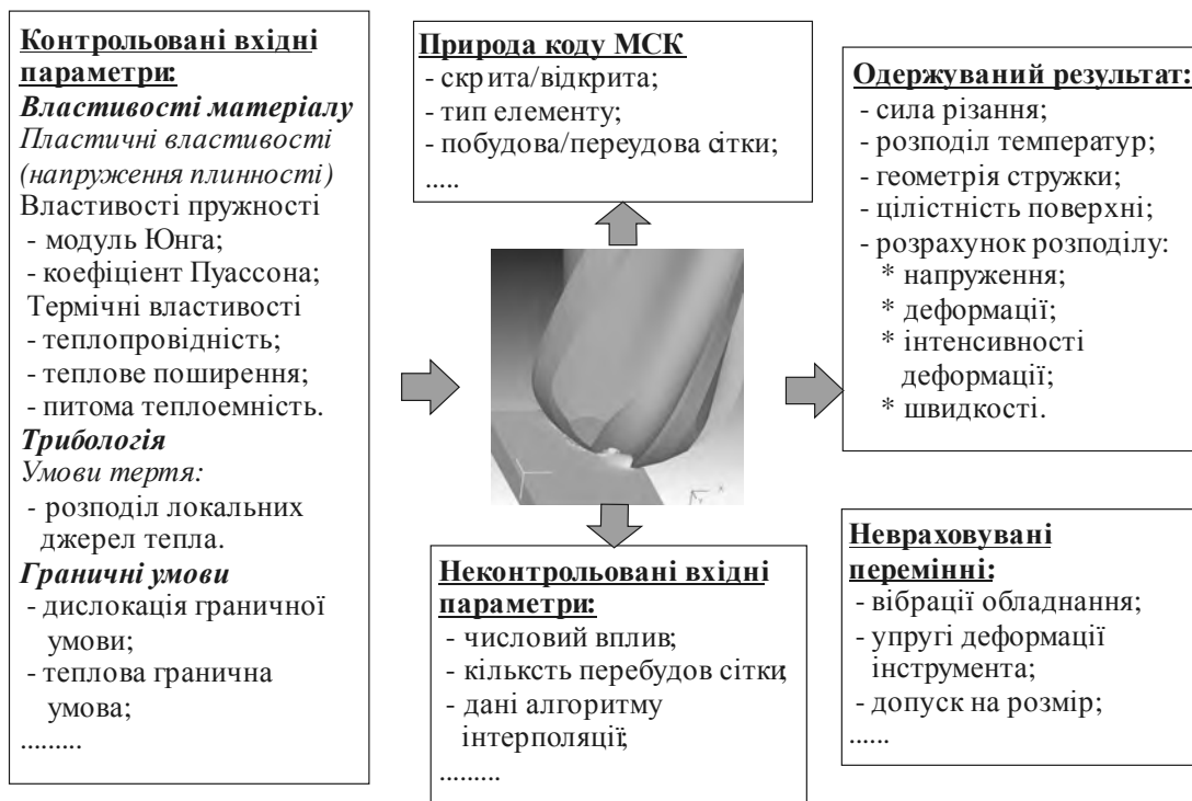
Рис. 4. Моделювання процесу косокутного різання загартованої сталі в середовищі 3D
