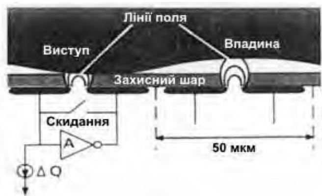
Рис. 4. Конденсаторний елемент для зчитування зображення
