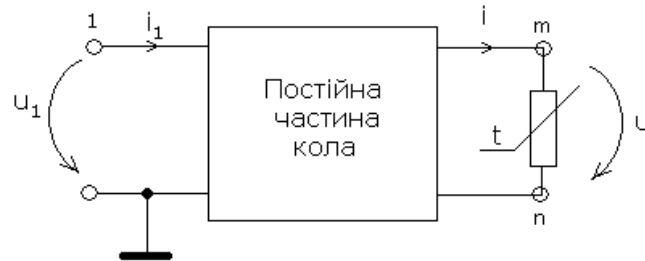
Рис. 1. Лінійне параметричне коло з одним параметричним елементом
