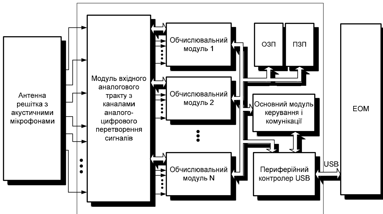
Рис. 1. Структура спеціалізованої комп’ютерної системи акустичної локації з використанням апаратних високопродуктивних обчислювальних модулів
