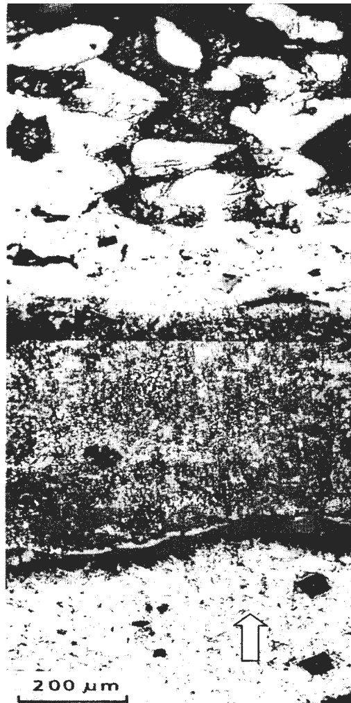
Рис. 2. Мікроструктура поперечного розрізу мікрошліфа сталі після комбінованого її зміцнення ЛПЗ і СВС. У напівпроплавленій зоні видно високотверді (~HV2000) карбіди TiC, які займають до 50 % об'єму всього шару карбідосталі. Світлою стрілкою показано напрям, вздовж якого розташовано лунки від індентора мікротвердоміра. Травлення виконувалось ніталем
