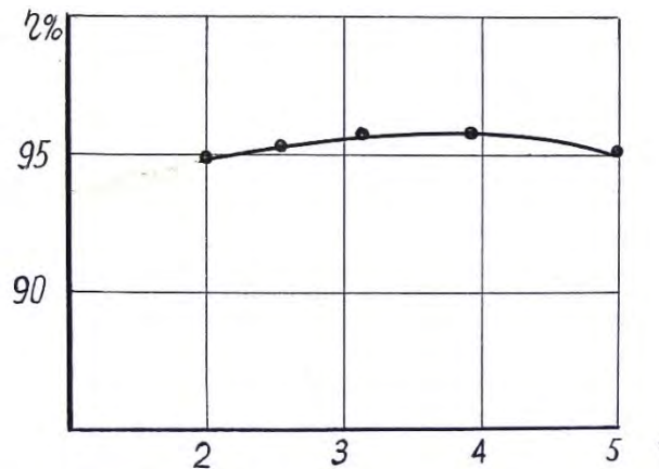
Рис. 4.24. Залежність ефективності пилоловлювання від швидкості проходження повітря через жалюзійну решітку ( D= 0,16 м.; решітка нерухома)
