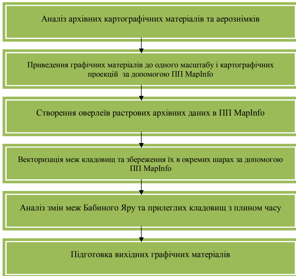
Рис.3.1. Технологічна схема відтворення історичних меж Бабиного Яру та прилеглих кладовищ
