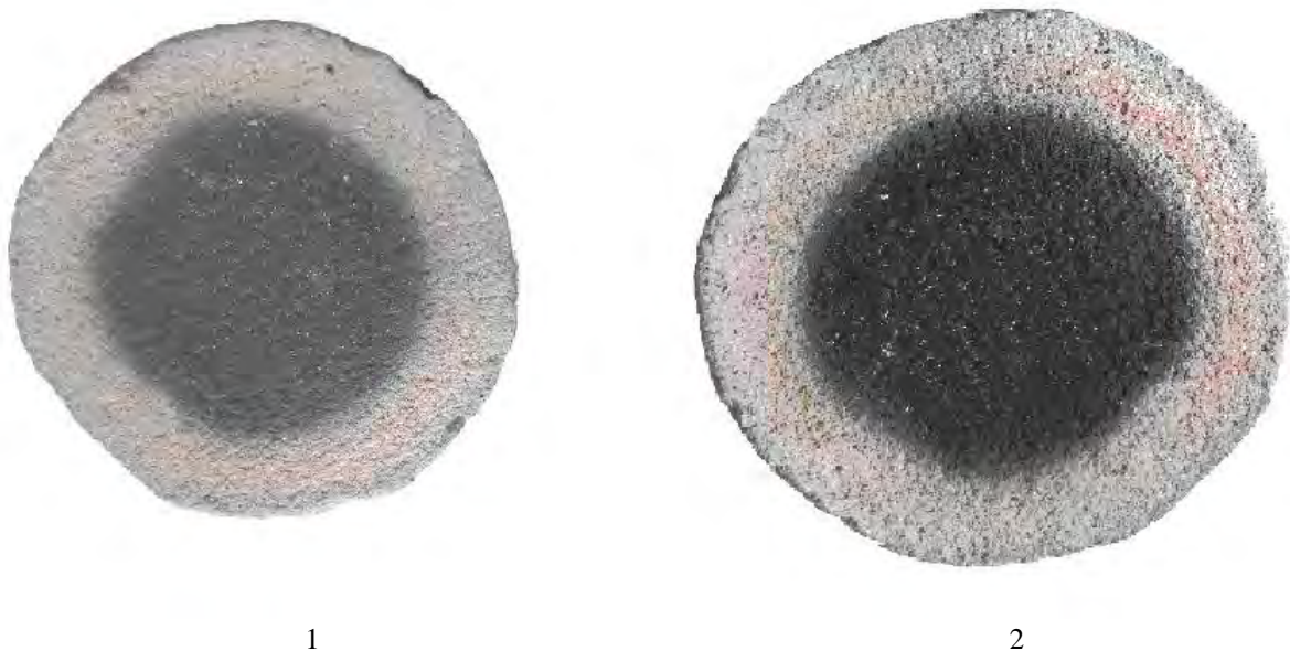
Рис. 4. Структура взірців, випалених за температури 950 °С: 1 – діаметр 55 мм, 2 – діаметр 65 мм
