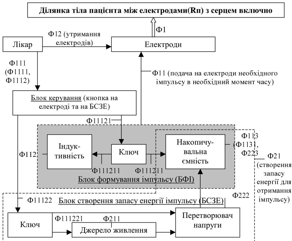
Рис. 4. Функціональна схема дефібрилятора
