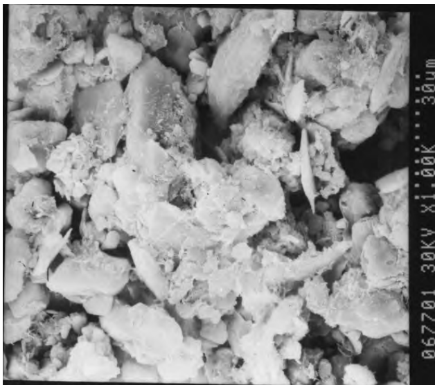
Рис. 1. Стереопара мікроповерхні лесового ґрунту, отримана на РЕМ "Hitachi" S-800 при M = 1000\times і кутах нахилу гоніометричного столика \alpha_n = 0^\circ , \alpha_n = +8^\circ
