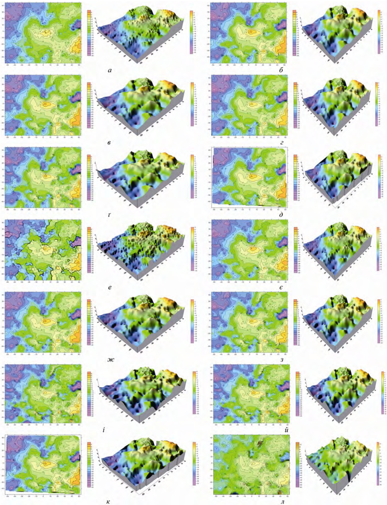
Рис. 3. Приклади графічного представлення мікроповерхні лесового ґрунту у вигляді мікропланів та 3D-моделей, побудованими різними математичними методами за 850 вимірними точками: а – обернено пропорційній до відстані у степені; б – Крайгінга (лінійна варіограма); в – Крайгінга (лін. вар. + врах. лін. тренду); г – Крайгінга (лін. вар. + врах. квадратич. тренду); г – мінімальної кривизни; д – природних околів; е – сусідніх околів; е – радіальних базисних функцій (РБФ), зворотн. мультіквадр; жс – РБФ, мультилогарифмічний метод інтерполювання; з – РБФ, мультіквадриковий; і – РБФ, кубічний сплайн; й – РБФ, сплайна гнучкої пластини; к – триангуляції з лінійною інтерполяцією; л – Шепарда (модифікований)
