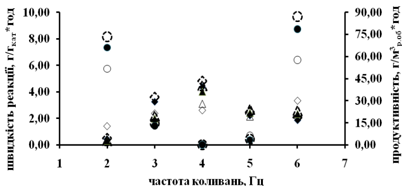
Рис.22 Адекватність моделі експериментальним даним синтезу вуглеводнів із синтез-газу методом Фішера-Тропша при атмосферному тиску та різному співвідношенні \text{CO}:\text{H}_2 ( T=503\text{ K} ; C_{\text{кат}}=10\text{ г/м}^3 )
