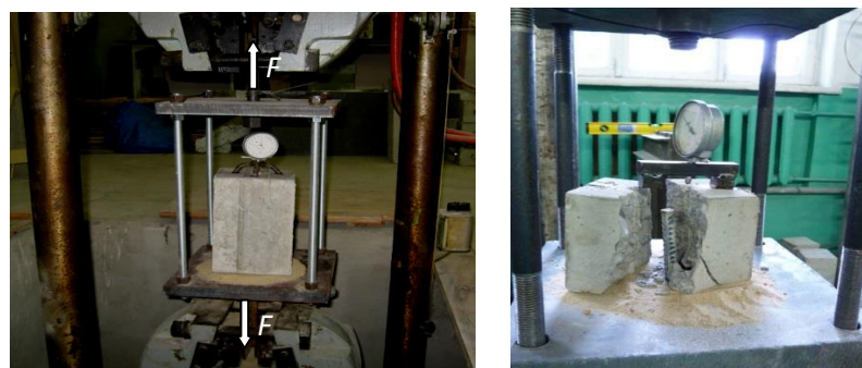
Рисунок 2 -Загальний вигляд випробування зразків у силевій установці та вигляд зразка після руйнування
