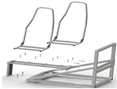
Рисунок 1 – Тривимірна рознесена модель каркаса сидінь з основою
