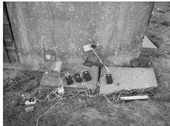
Рис. 2. Пожежне навантаження (а) та реєструвальні прилади ПКРТ-0103 (б)
