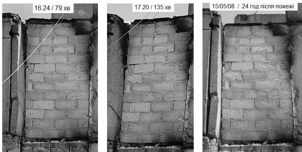
Рис. 6. Конструкція стіни під час випробувань, неекспонована поверхня
