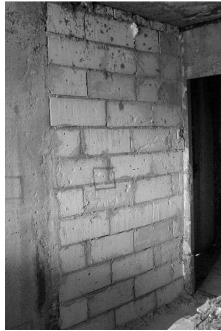
Рис. 1. Конструкція, підготовлена до випробувань: а – вигляд з неекспонованої сторони; б – експонована сторона на вплив пожежі
