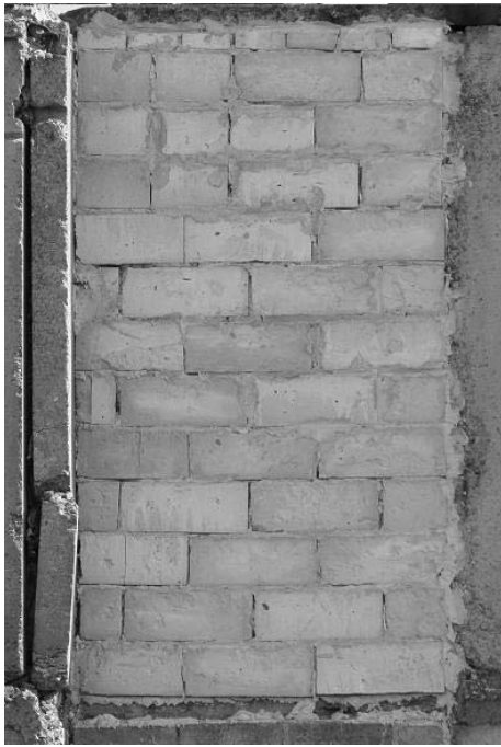
Рис. 1. Конструкція, підготовлена до випробувань: а – вигляд з неекспонованої сторони; б – експонована сторона на вплив пожежі
