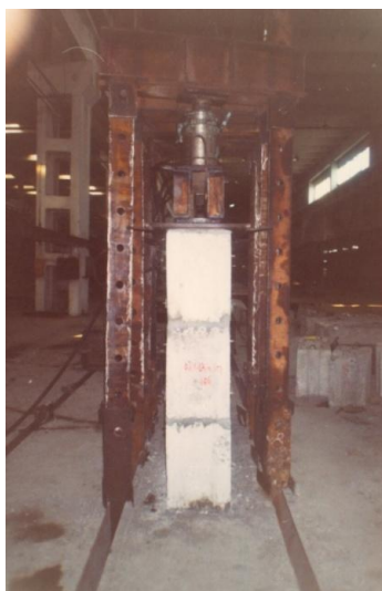
Рис. 3. Конструкція і умови завантаження експериментальних фундаментних блоків в складі фрагментів стін: 1 – суцільні бетонні блоки стін підвалів марки ФБС-24.4-6 за ГОСТ 13579; 2 – експериментальні блоки марки 2ФБП; 3 – експериментальний блок марки 3ФБП; 4 – порожнисті блоки (половинчасті до блоків з 2-ма порожнинами); 5 – експериментальні блоки марки 4ФБА з арболітовими вставками
