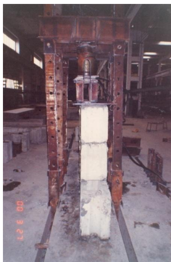
Рис. 3. Конструкція і умови завантаження експериментальних фундаментних блоків в складі фрагментів стін: 1 – суцільні бетонні блоки стін підвалів марки ФБС-24.4-6 за ГОСТ 13579; 2 – експериментальні блоки марки 2ФБП; 3 – експериментальний блок марки 3ФБП; 4 – порожнисті блоки (половинчасті до блоків з 2-ма порожнинами); 5 – експериментальні блоки марки 4ФБА з арболітовими вставками
