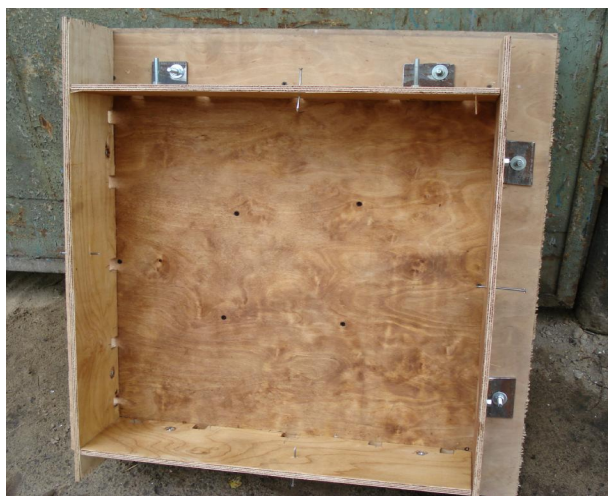
Рис. 1. Форма для виготовлення дослідних зразків торкрет-бетону
