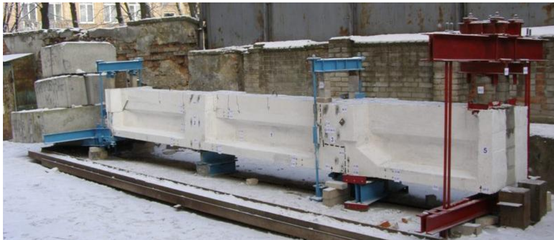
Рис. 3. Загальний вигляд дослідної надопорної конструкції балки монолітної ділянки на стенді
