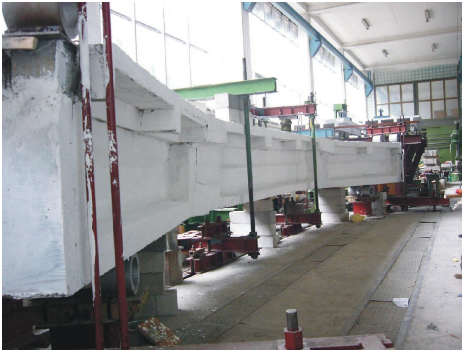
Рис. 5. Загальний вигляд випробувань досліджуваної конструкції прогонової будови на кривій
