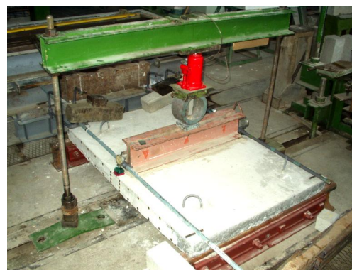
Рис. 1. Загальний вигляд випробування залізобетонних плит з моделюванням мінливості кроків горизонтальної робочої арматури
