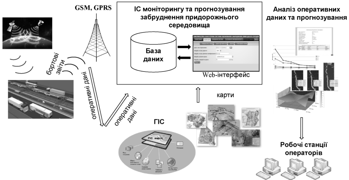
Рисунок 1. Загальна принципова схема інформаційно-аналітичної системи оцінювання забруднення придорожнього середовища транспортними потоками
