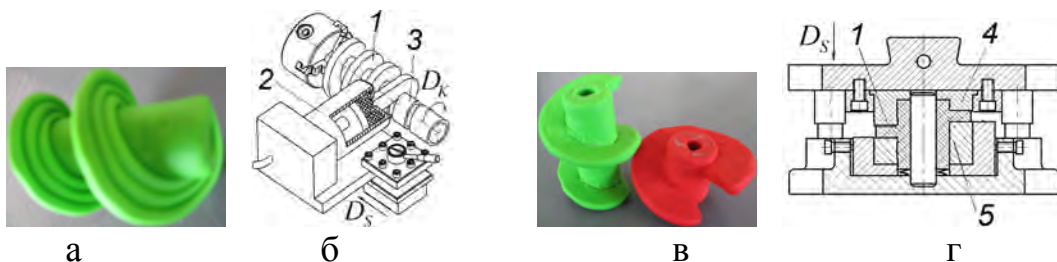
Рис. 3. Загальний вигляд полімерних ШЗ (а, в) та схеми їх формоутворення (б, г): 1 - ШЗ, 2 – екструдер, 3 – оправа, 4 і 5 – матриця і пуансон
