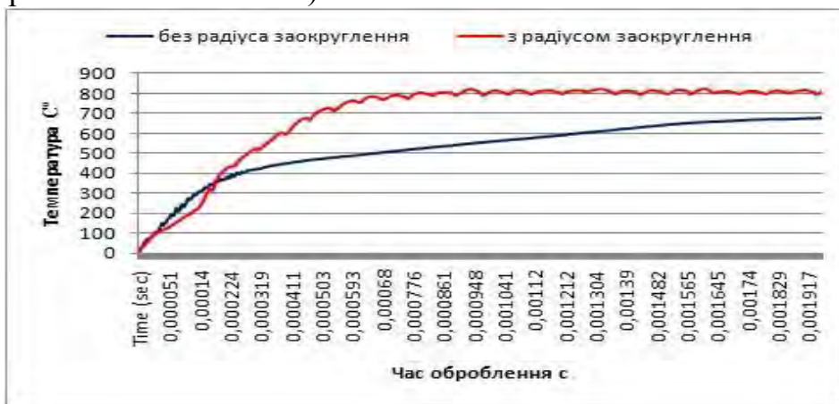
Рис.1 Графік залежності температури, в зоні стружкоутворення, від радіуса заокруглення різуючої кромки.
