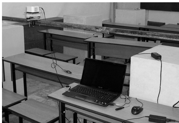
Рис. 3. Інклінометр встановлений на рамі та під'єднаний до комп'ютера.
