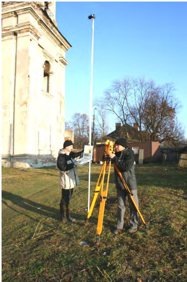
Рис. 2. Знімання фасаду цифровою камерою зі штанги.
