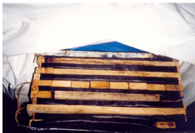
Рис. 13 . Схема (а) та загальний вигляд (б) термовакuumної установки сушіння деревини із еластичною оболонкою
