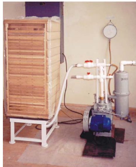
Рис. 20. Схема (а) та загальний вигляд (б) лоткової термовакуумної сушильної установки
