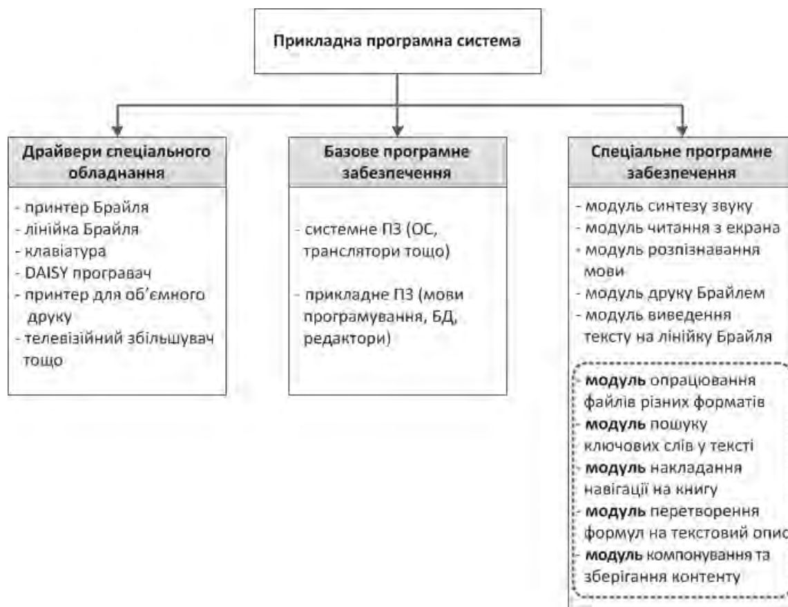
Рис. 2. Структурна схема прикладної програмної системи опрацювання українськомовних технічних текстів для людей з вадами зору
