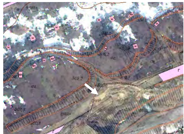
Рис. 5. Зміни на місцевості внаслідок руйнування зовнішньої межі кар'єру Fig. 5. Changes on the terrain because of the destruction of the outer boundary of quarry
