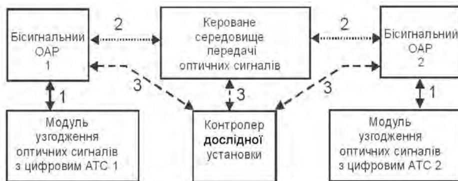
Рис. 11. Структурна схема дослідної установки для передавання оптичних даних:
