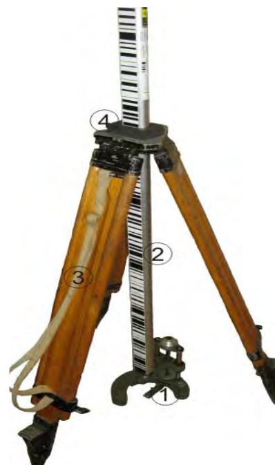
Рис. 2. Рейка на підйомному механізмі: 1 – підйомний механізм; 2 – штрихкодowa рейка; 3 – штатив; 4 – фіксатор штрихкодowoї рейки
