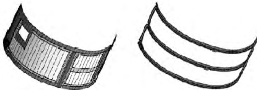
Рис. 2. 3D модели панели и каркаса
