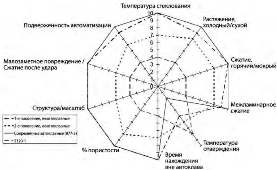
Рис. 1. Сравнение материалов, полученных в автоклаве и неавтоклавым способом
