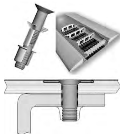
Рис. 11. Обеспечение молниезащиты топливных отсеков в зоне соединений
