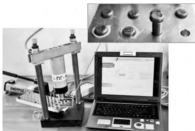
Рис. 8. Отработка технологии постановки болтов в отверстия по переходной посадке Н9/м8
