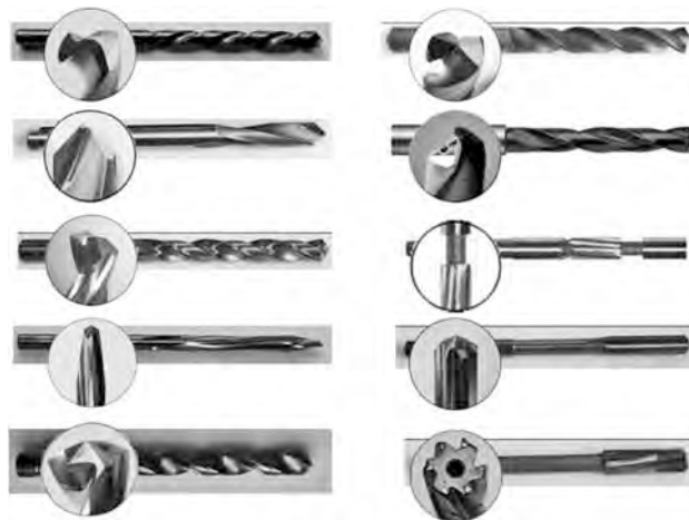
Рис. 2. Режущий инструмент компаний Sandvik, Guhring, Прескорп и других, использованный при отработке технологии обработки отверстий
