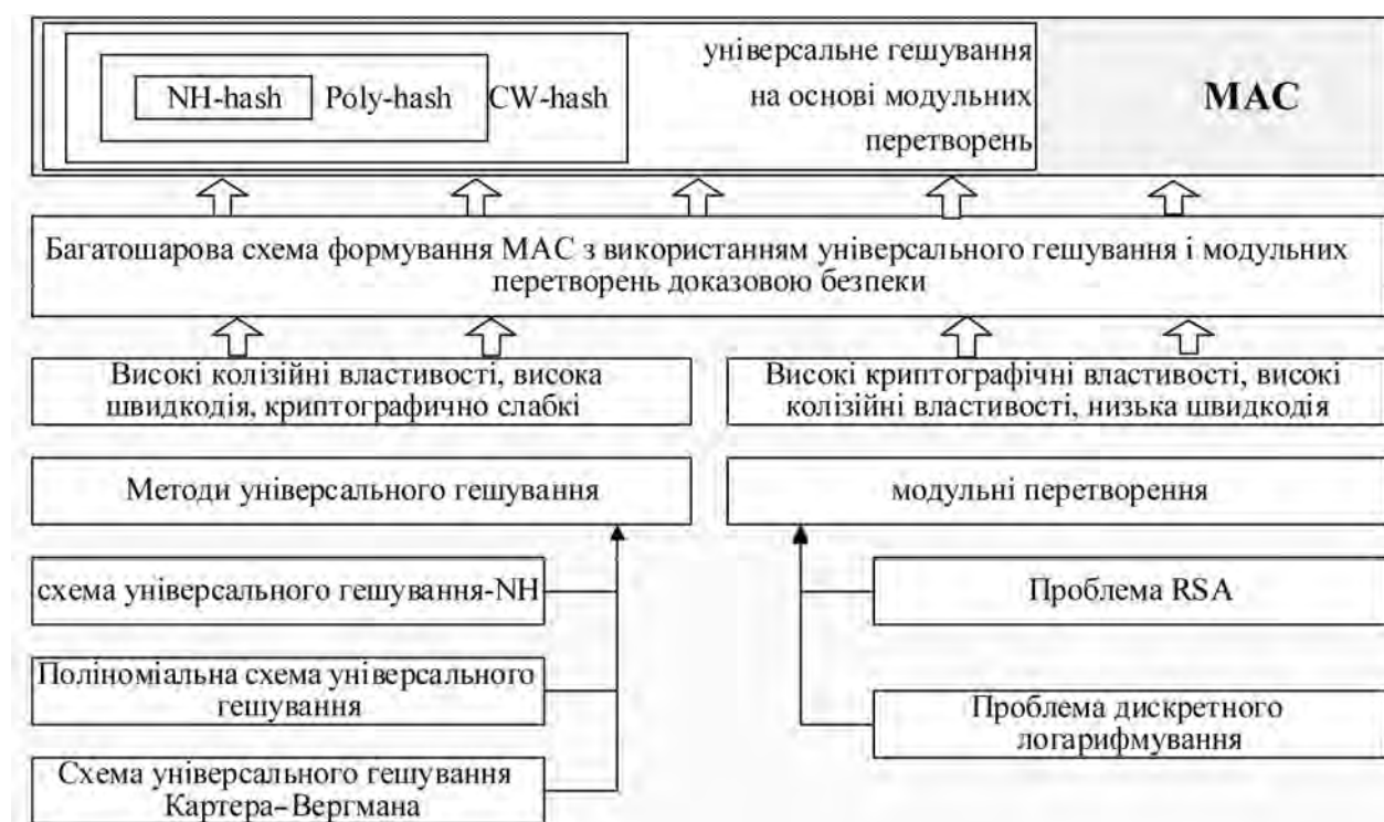
Схема каскадного формування кодів контролю цілісності й автентичності даних з використанням модульних перетворень
