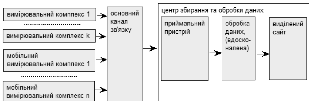
Рис. 4. Система моніторингу з використанням стаціонарних та мобільних вимірювальних комплексів
