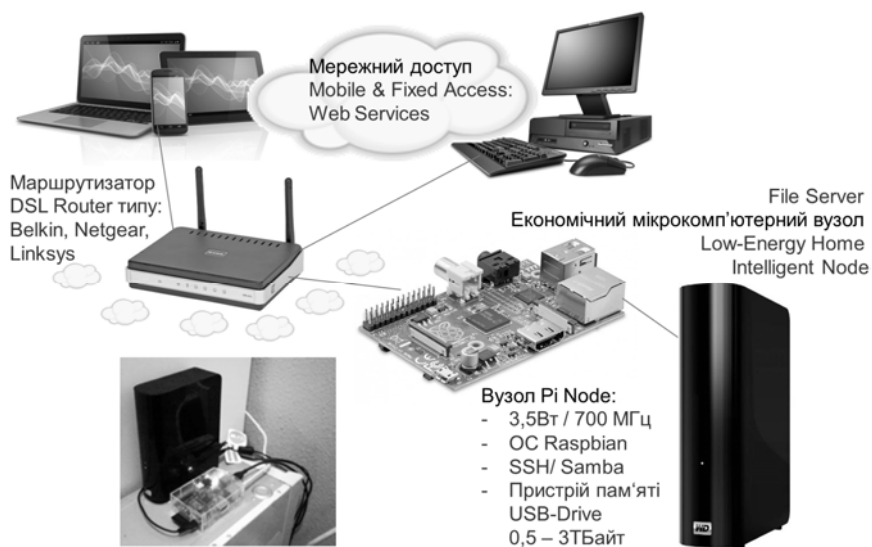
Рис. 6. Приклад енергетично ефективного сервісу типу File Server (Private Cloud Storage) на основі мікрокомп'ютерного вузла Raspberry Pi
