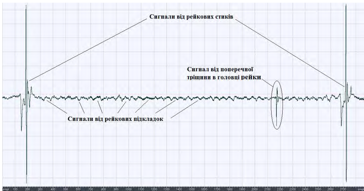
Рис. 2. Фрагмент дефектоскопічного сигналу з наявним у ньому сигналом від поперечної тріщини в рейці, отриманий під час заїзду Львів – Сянки – Чоп, 06.11.2009 р. (км:36, пікет:6, швидкість: 47 км/год)
